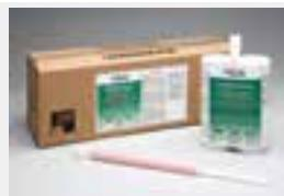
**Typ:** 2-Komponenten-PU-Kleber**Einsatzbereich:** ROYAL Millennium One Step Green® für die Verklebung von FOAMGLAS® Platten, FOAMGLAS® READY BOARD / FOAMGLAS® READY BLOCK oder FOAMGLAS® ROOF BOARD G2. (siehe TDS)**Konsistenz:** Pastös**Farbe:** Weiß-gelb**Verarbeitungstemperatur (Luft + Untergrund):** +5 °C bis +35 °C**Lagerungszeit:**\* Siehe Etikett. Trocken, frostfrei, sonnen- und wärmegeschützt lagern.**Verbrauch:** Bei 4 Klebestreifen pro Meter: ca. 185 - 200 g/m<sup>2</sup>
