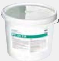
**Typ:** Reaktivier, lösemittelfreier Zweikomponenten-Kleber**Einsatzbereich:** Verkleben von FOAMGLAS® Platten/Boards auf Beton, bituminösen Dachbahnen und auf Stahltrapezblechen.**Konsistenz:** Pastös**Farbe:** Komponente A: schwarz; Komponente B: rot/braun**Lösungsmittel:** Keine**Verarbeitungstemperatur (Luft + Untergrund):** +5 °C bis +40 °C**Verarbeitung:** Der Kleber wird von Hand mit Hilfe eines Zahnpachtels oder YTONG-Kelle verarbeitet.
